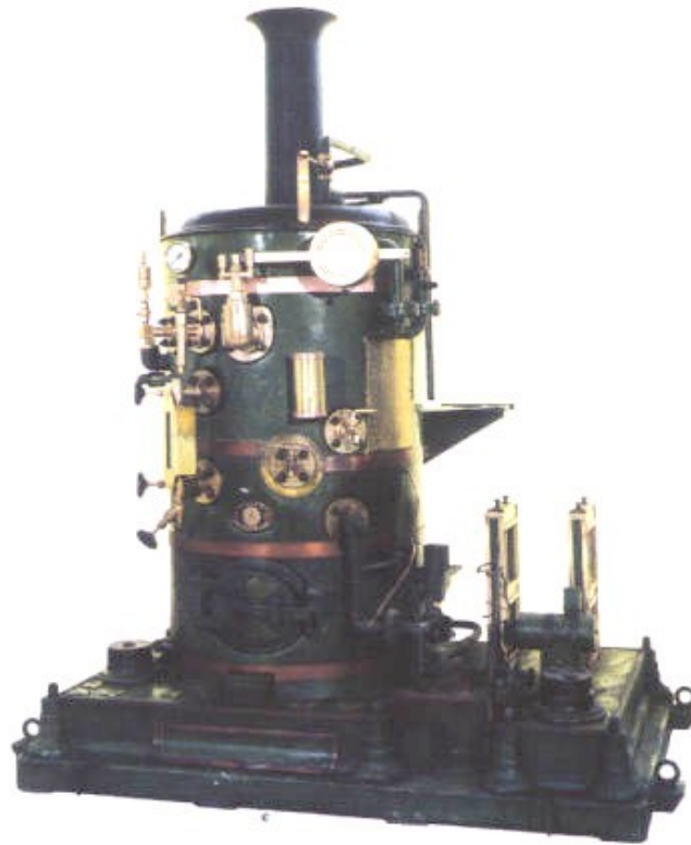
Caldaia a tubi di fumo verticali
